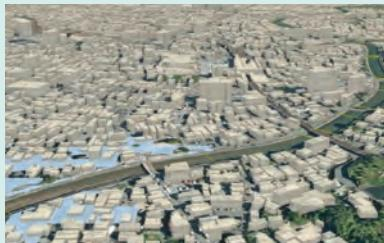
3D浸水想定図による水害リスクの見える化
