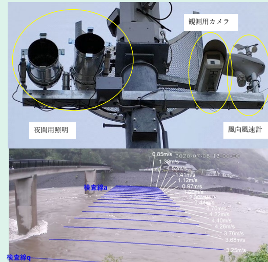
カメラ映像による流速自動計測
