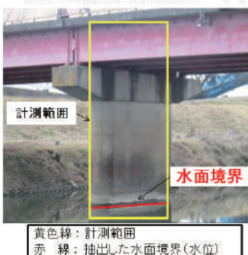
輝度変化を利用した水位計測の原理
