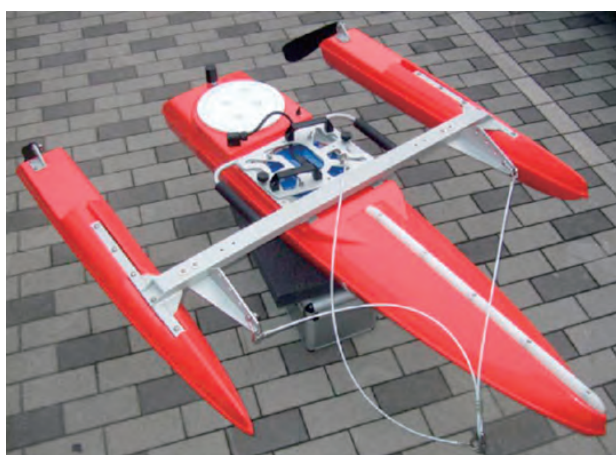
高流速対応トリマラン型ADCPボート
