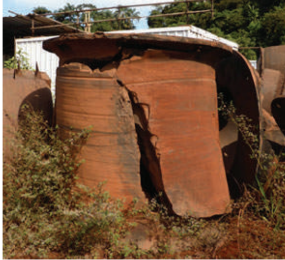
Fig. 19 Broken actual fender: 2000H (42 years)
