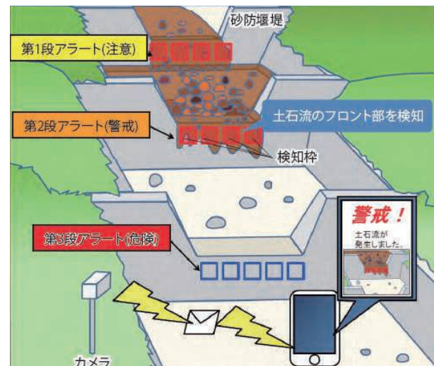
土石流検知アラートシステム
