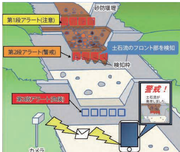
土石流検知アラートシステム
