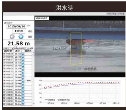
CCTVカメラによる河川水位計測システム
