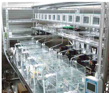
流水式試験装置によるメダカのばく露試験
