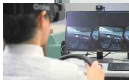
ドライビングシミュレータによる道路安全性評価
