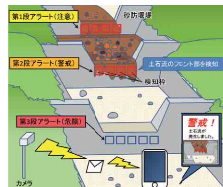
土石流アラートシステム
