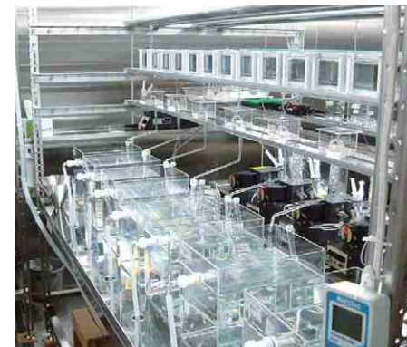
流水式試験装置によるメダガのばく露試験
